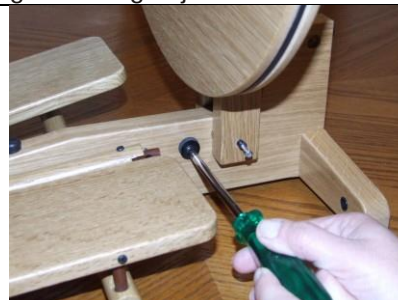
STAP 6: Verwijder de stopbuffer
