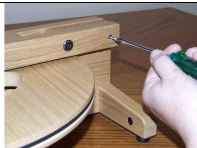
STAP 3: draai een schroef in het geboorde gaatje
