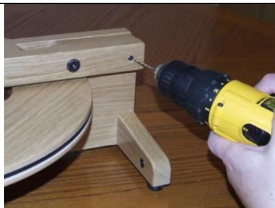
STAP 2: boor een gaatje in de steel van de afgebroken knop
