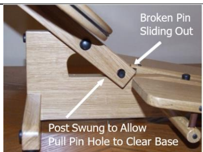
STAP 7: Verwijder de defecte pen
