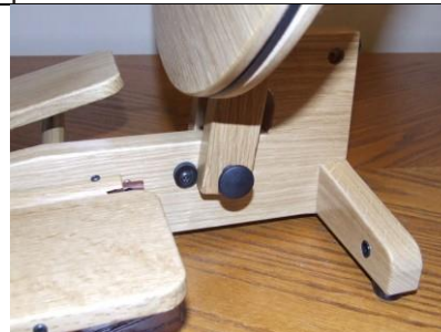
STAP 12: Stel de positie van de buffer af zodat de staander goed vast staat
