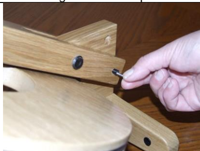
STAP 5: Trek aan de schroef en vouw het wiel open
